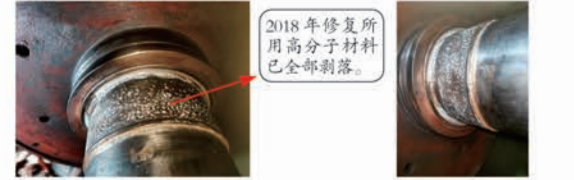
附图 6:打磨后集电环;附图 7:发电机非驱动端轴电蚀;附图 8:发电机非驱动端轴电蚀
